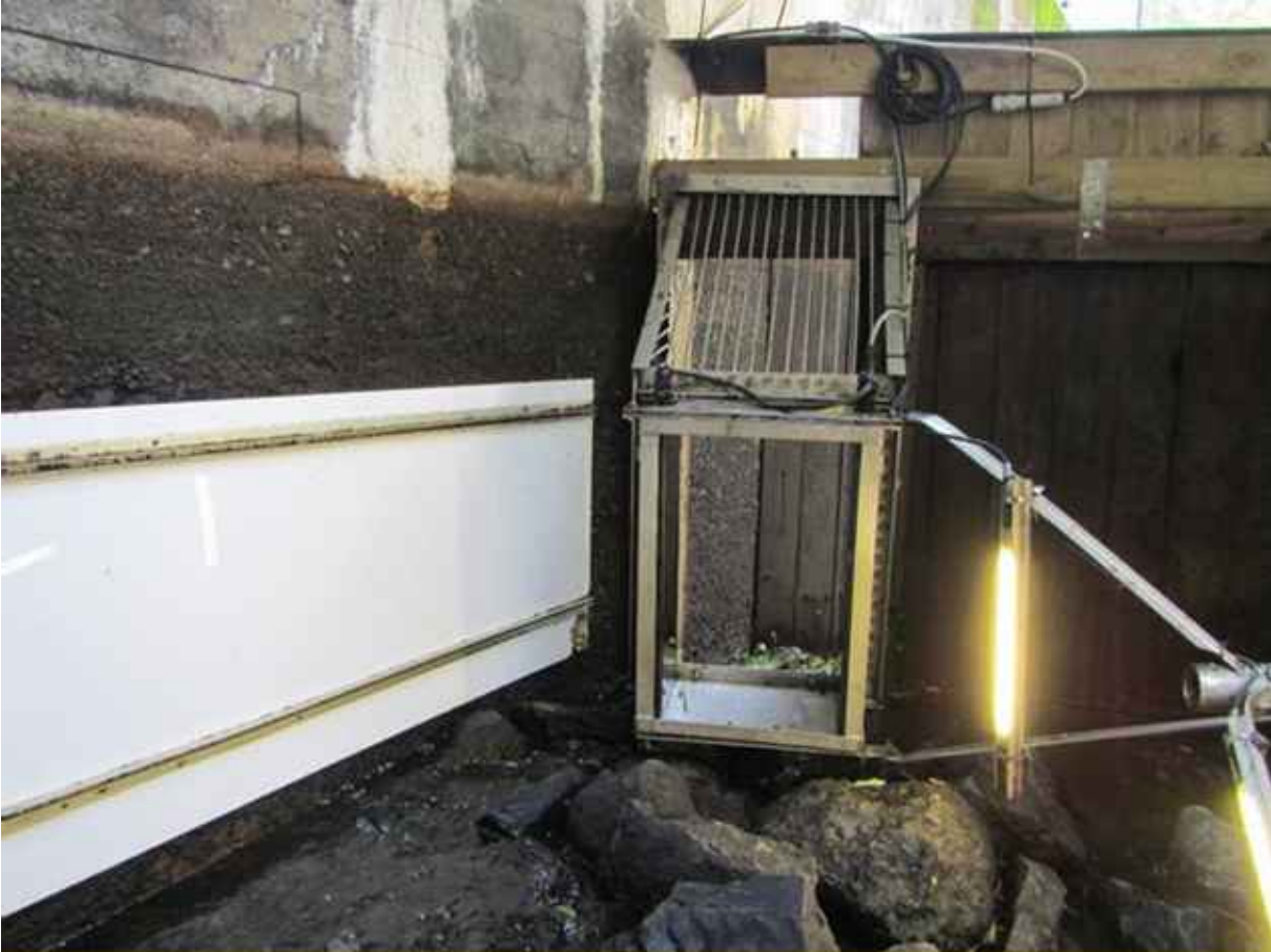
Kuva 1. Koivukosken säännöstelypadon kalaportaaseen asennettu Vaki-kalalaskuri, ohjauskehikko sekä kalojen lajintunnistuksessa apuna käytetty videokamera valoineen.
